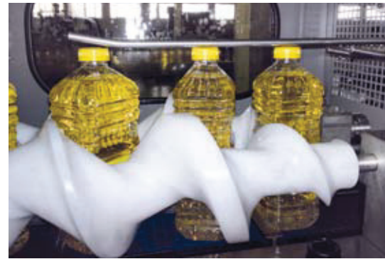
Arriba: el nuevo dispositivo en la entrada del DV500 permite orientar las botellas con asa en la posición deseada.
