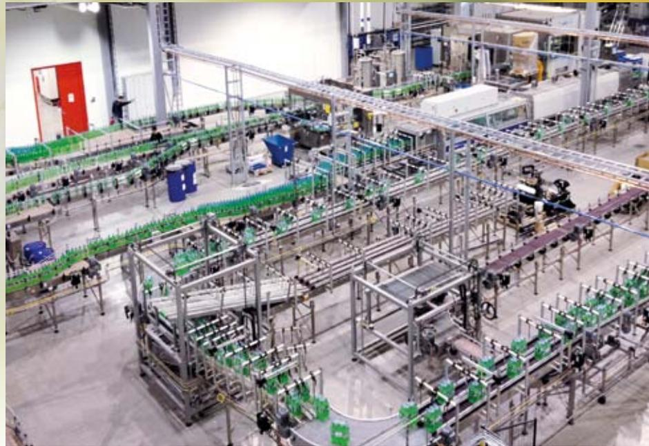
otros dispositivos automáticos situados en distintos puntos de la línea inspeccionan los envases vacíos, controlan el nivel de llenado y la correcta aplicación de los tapones
