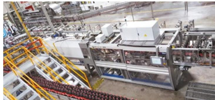
Para el embalaje secundario de las botellas PET de los productos de las marcas Coca Cola y Ciel, Bebidas Refrescantes de Nogales se dirigió a SMI, a la que compró una empaquetadora compacta de la serie CSK provista de túnel de termorretracción con gas metano, así como una serie de cintas transportadoras para botellas a granel y productos envasados.
