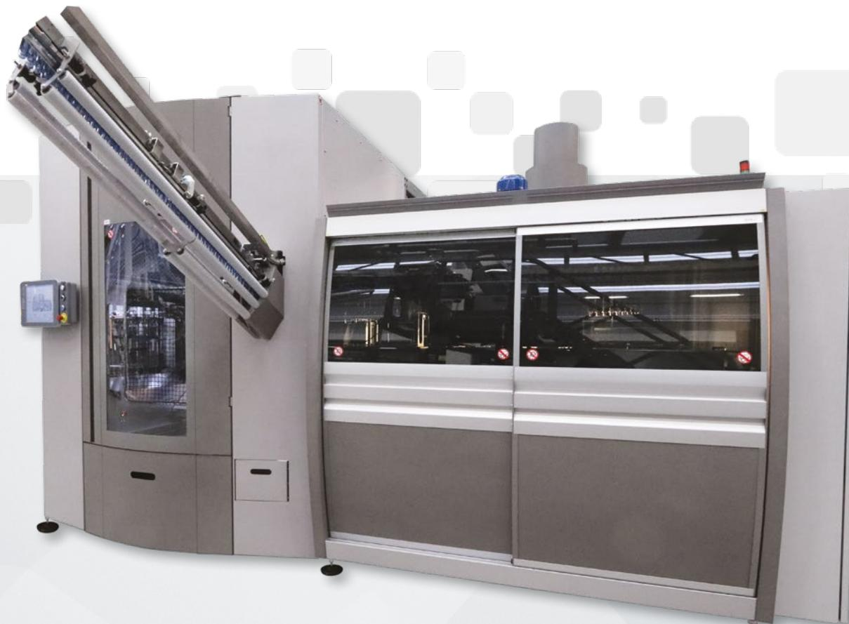
Le projet EBS E ERGON prévoit des procédés totalement électroniques qui permettent d'éliminer tous les mouvements mécaniques et les cames relatives et rendent ainsi la souffleuse réellement une machine cam-less\* (sans cames).
