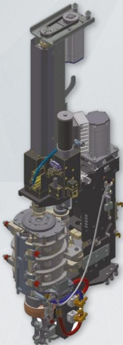
» Nouveau et compact module de chauffage des préformes
