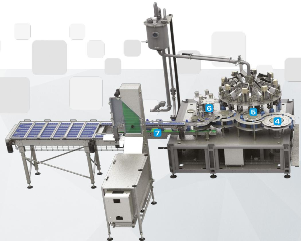
alors que débute la phase de décompression/sniff: un canal spécifique canalise la pression restante dans la bouteille à un collecteur dédié qui décharge à l'extérieur du bloc de remplissage. La bouteille remplie est à ce point transférée au boucheur.
