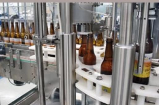
**C**ada cerveza se distingue por su sabor único y particular, que debe ser conservado hasta que llegue al consumidor para que éste pueda apreciar su calidad y sabor; por lo tanto, para mantener intactas las características del producto, es fundamental contar con máquinas y sistemas de producción fiables y eficientes, como las monobloques de enjuague, llenado
