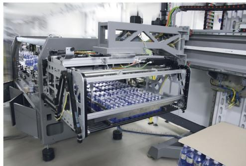
导轨的滑动，确保了顺畅、连续和精确的动作，并且将弯曲动态减至最少并大大降低了振动。所有这些都能够减少机械部件的磨损，并且由此能够确保在机器的整个寿命周期内出色的运行稳定性、更少的维护需要和低运行成本。
